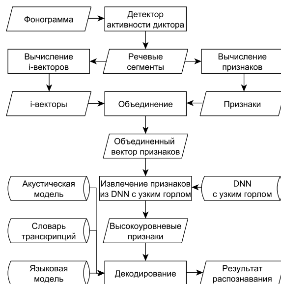
Рисунок 3 — Схема подсистемы распознавания речи
